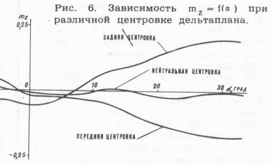
Рис. 6. Зависимость  $m_z = f(\alpha)$  при различной центровке дельтаплана.
